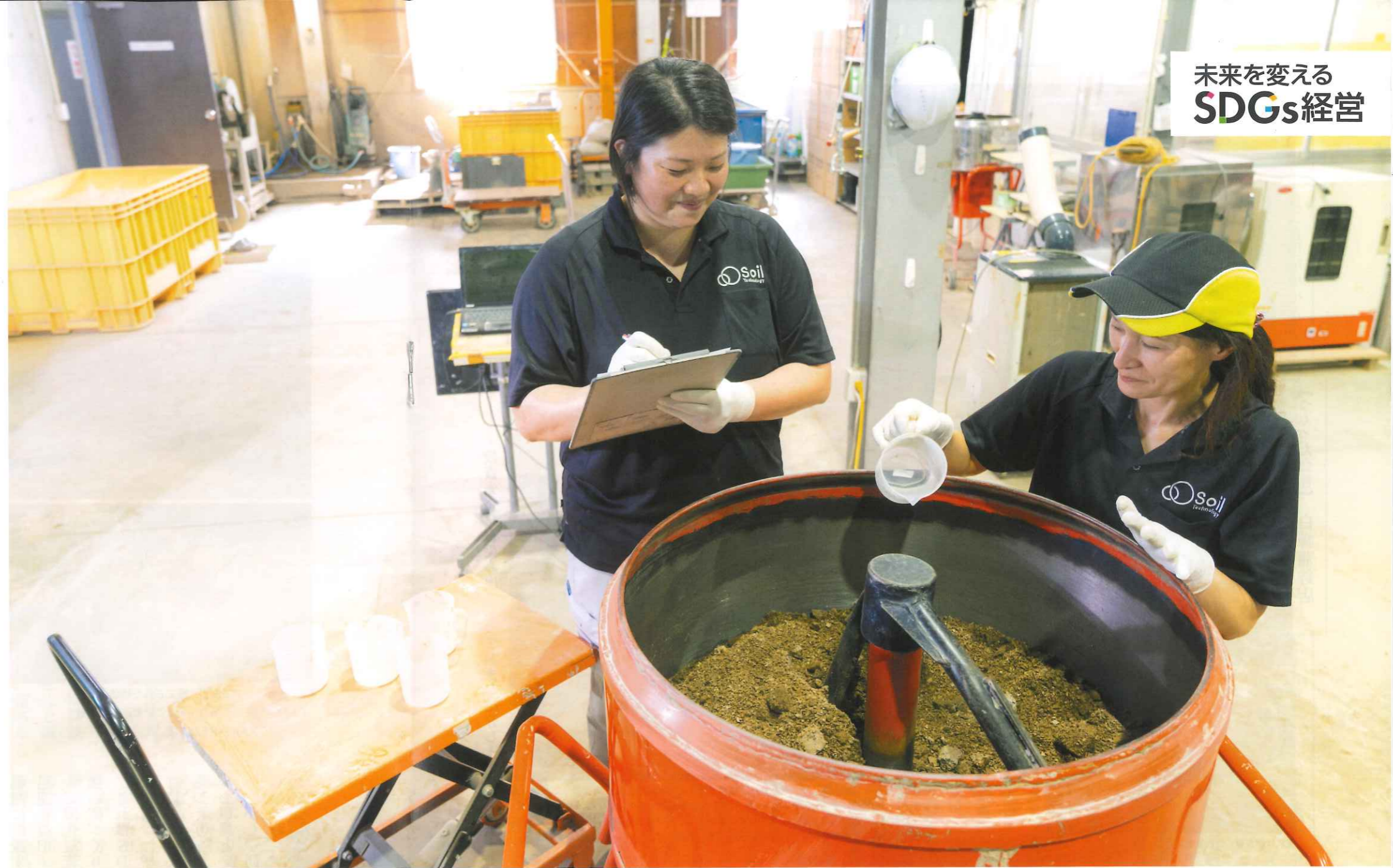
現地土砂を社内に運び、その性質を調べる様子。それぞれ性質が異なる土砂の最適な硬化方法を調べる。
