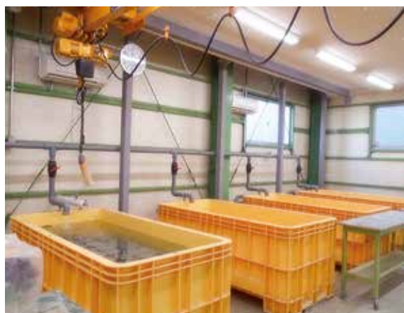
砂防ソイルセメントの水中養生
