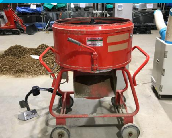
土砂、水、セメント・ 固化材を混合し、 砂防ソイルセメントを製造
