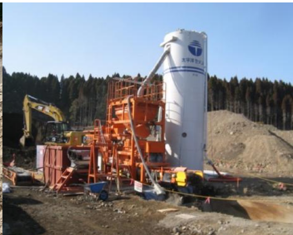
土砂、水、セメント・ 固化材を混合し、 砂防ソイルセメントを製造
