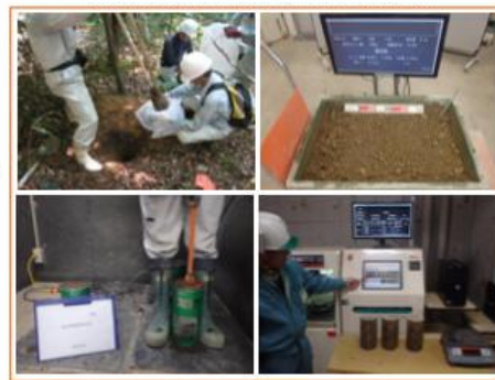
土砂採取,配合試験,強度管理状況
